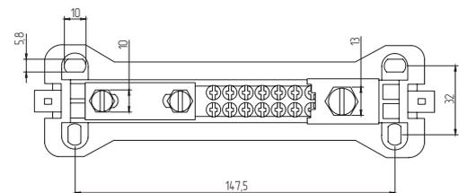
Шина уравнивания потенциалов предназначена для организации дополнительной системы уравнивания потенциалов в квартирах, домах, офисах и производственных помещениях — шина объединяет защитные проводники электрического оборудования и подключается к ГЗШ. Шина уравнивания потенциалов выполнена из латуни и имеет пластиковый кожух.
