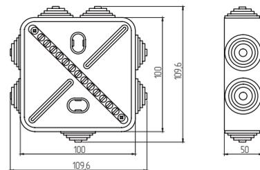
Коробка уравнивания потенциалов предназначена для организации дополнительной системы уравнивания потенциалов в квартирах, домах, офисах и производственных помещениях — коробка объединяет защитные проводники электрического оборудования и подключается к ГЗШ. Коробка уравнивания потенциалов выполнена из пластика в герметичном исполнении со степенью защиты IP 55.
