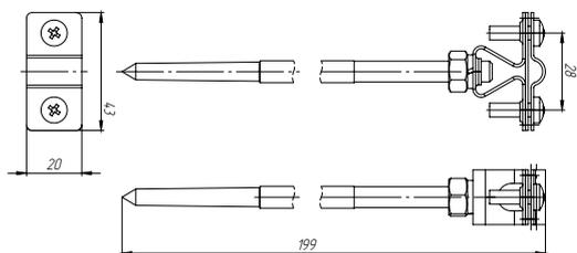
Держатель проводника круглого для бетонного фасада
