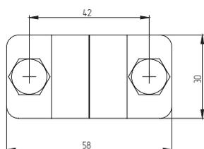
Зажим позволяет выполнить соединение в параллельном направлении прутков диаметром 8-10 мм между собой. Зажим стягивается болтами М8. Латунный зажим позволяет соединить коррозионно несовместимые металлы.
