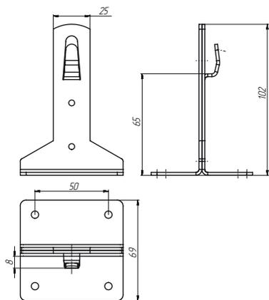
Держатель проводника круглого для конька, высота 110 мм
