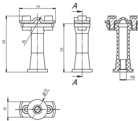
Держатель проводника круглого, высота 65 мм
