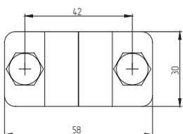
Зажим позволяет выполнить соединение в параллельном направлении прутка диаметром 8-10 мм со стержнем либо молниеприемником диаметром 16 мм. Зажим стягивается болтами М8. Латунный зажим позволяет соединить коррозионно несовместимые металлы.
